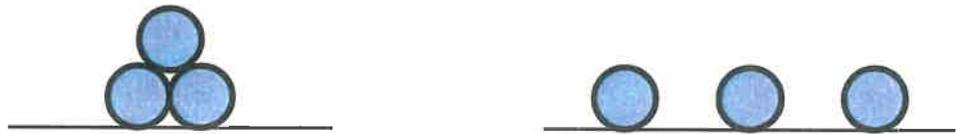
**Abbildung 5:** Schematische Anordnung Kabel Dreiecksverlegung (links) und Flachverlegung (rechts)
